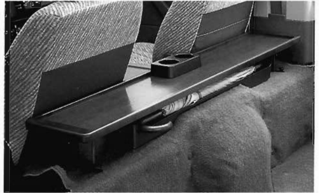
④④アップライトテーブル：ドリンクホルダー、アンブレラケースが付き多機能テーブル。広葉木材(ダミン)+ABS樹脂。 サイズ/1370(W)×145(H)×210(D) MZ526553 ¥32,400(含む参考取付工賃 ¥2,400)
