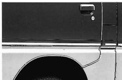
⑲ ドアエッジモール :サイドのスタイリングをシャープに。傷つき防止のステンレス製。
