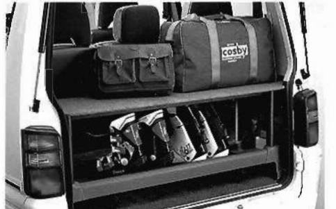
④⑪スキーブーツケース：濡れたスキーブーツや汚れものなども安心して収納できます。合板+FRP製グレイ。 サイズ/ケース部 φ1481(W)×250(H)×360(D) シェルフ部 φ1480(W)×380(D) MZ522571 ¥45,400(含む参考取付工賃 ¥2,400)
