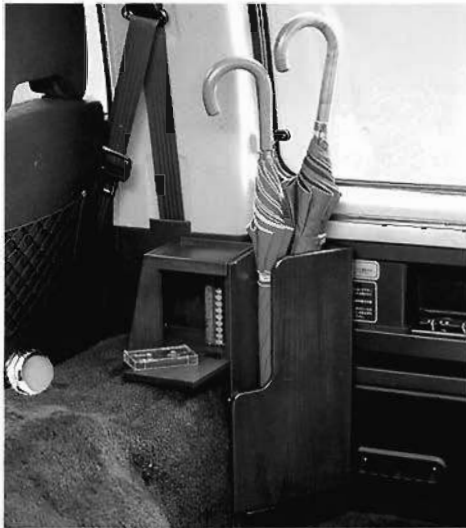
⑤⑥コーナーキャビネット:キャビンコーナーに設置。アンブレラケースと小物収納ボックスを持つ便利なキャビネットです。 サイズ/ケース部⑤⑥175(W)×520(H)×155(D) ボックス部⑤⑥150(W)×180(H)×200(D) MZ524518 ¥31,400(含む参考取付工賃 ¥2,400)
