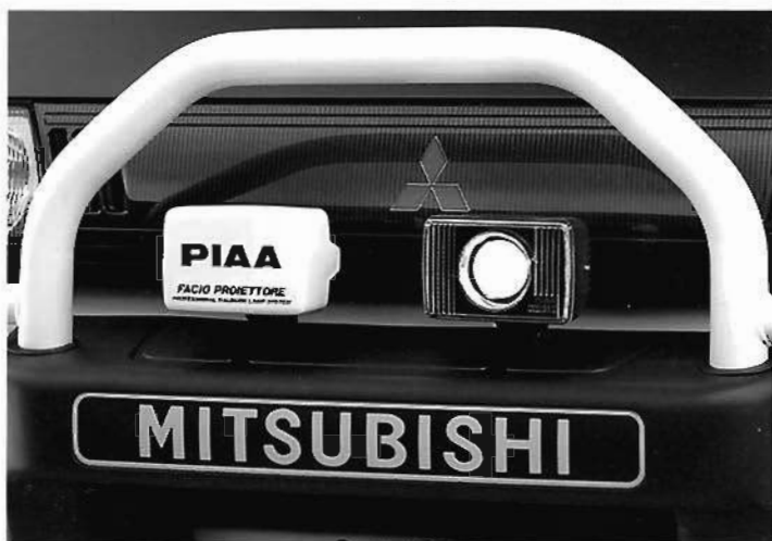
⑧フォグランプ<A>(PIAA製プロジェクタータイプ) 55Wハロゲン/ランプカバー付。MZ581365 ¥54,000(含む参考取付工賃 ¥6,000)
