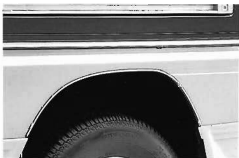
⑲ ドアエッジモール :サイドのスタイリングをシャープに。傷つき防止のステンレス製。
