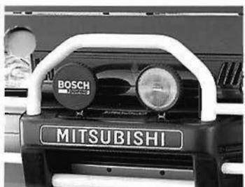
⑩フォグランプ<C>：おしゃれなボッシュのカバー付。55Wハロゲンバルブ、ボッシュ製。 MZ581248 ¥31,000 (含む参考取付工賃 ¥6,000)
