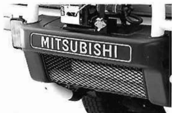
⑥フロントアンダースクリーン：フロントガードバーの下部をブラック・メッシュでドレスアップ。アルミ製品、ブラック。 MZ555085 ¥32,400(含む参考取付工賃 ¥2,400)
