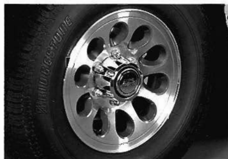
㉑ アルミホイール: 6JJ・15 オフセット22mm フロント用……MZ556021 ¥32,200(1本)(含む参考取付工賃 ¥4,200) リヤ用……MZ556022 ¥32,200(1本)(含む参考取付工賃 ¥4,200) ※オートフリーホイールハブ未装着車の場合は、リヤ用を4本使用。 ※フロント用とリヤ用は付属のセンターキャップが異なります
