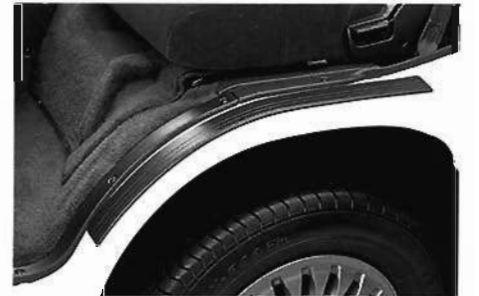
⑥⑦ ステップガード: 乗降時のすべり止めやキズ防止に最 適。塩ビ製、ブラック。 MZ526528 ¥3,700(含む参考取付工賃 ¥1,200)
