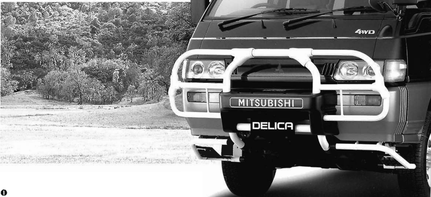
⑤ スタイリングバー：4WDのハードなイメージをさらに強調するドレスアップオプション。 標準装備のフロントガードバーに増設。スチールパイプ+樹脂(ジョイント部)。 ガードとしての機能はありません。
