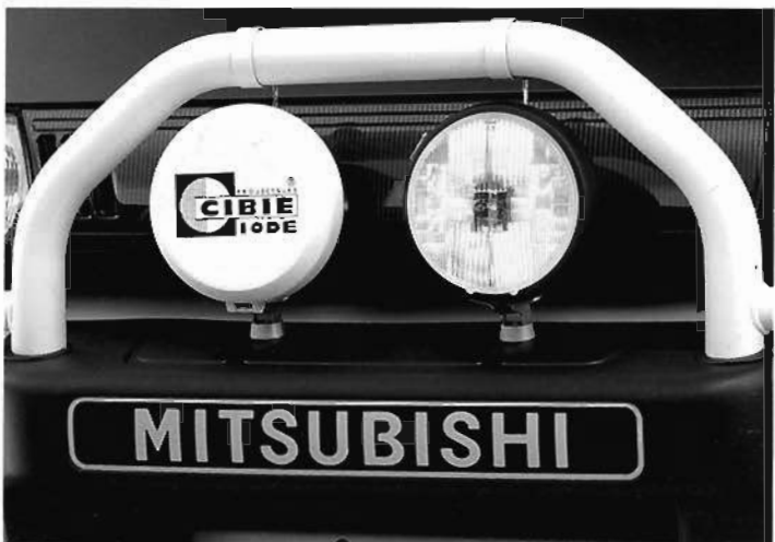
⑨フォグランプ<B>(CIBIE製オスカープラス) 55Wハロゲン/クリアレンズ、ランプカバー付。MZ581216 ¥42,000(含む参考取付工賃 ¥6,000)
