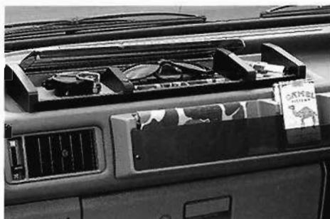
⑤⑦ダッシュトレイ:ダッシュボード上に取付け。小物の落下を防止するアクリル製フタ付きです。合板+アクリル製、ブラック。 サイズ/⑤⑦390(W)×40(H)×110(D) MZ520513 ¥6,700(含む参考取付工賃 ¥1,200)
