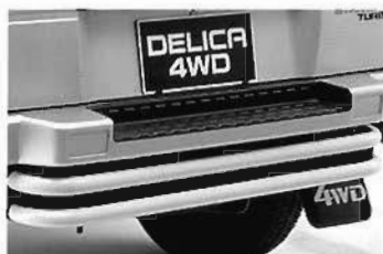
⑦リアアンダーガード：標準装備のアンダーガードを取り外して装着。スチールパイプ製。ホワイト。※牽引時は取り外しとなります。
